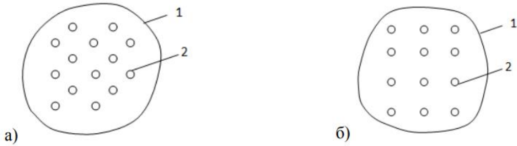
3-сурет. а) үш нүктелі және б) ұңғымаларды орналастырудың төрт нүктелі жүйелері. 1-мұнай құйылу контуры; 2-өндіру ұңғымалары
